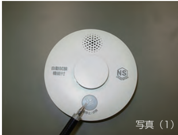
煙感知式火災警報器 写真 (1)
